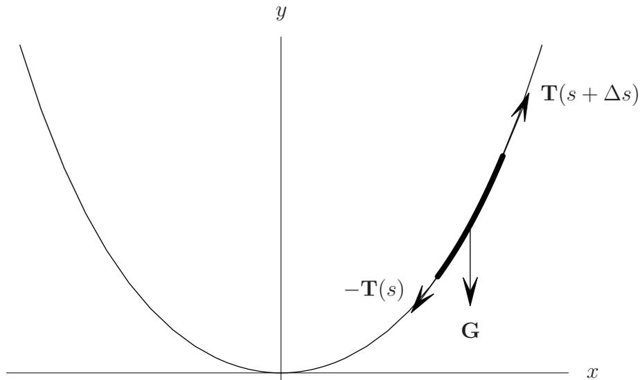
Abbildung 1.2: Die beiden Spannkraften und die Gewichtskraft am Seilstück der Länge  $\Delta s$ .
